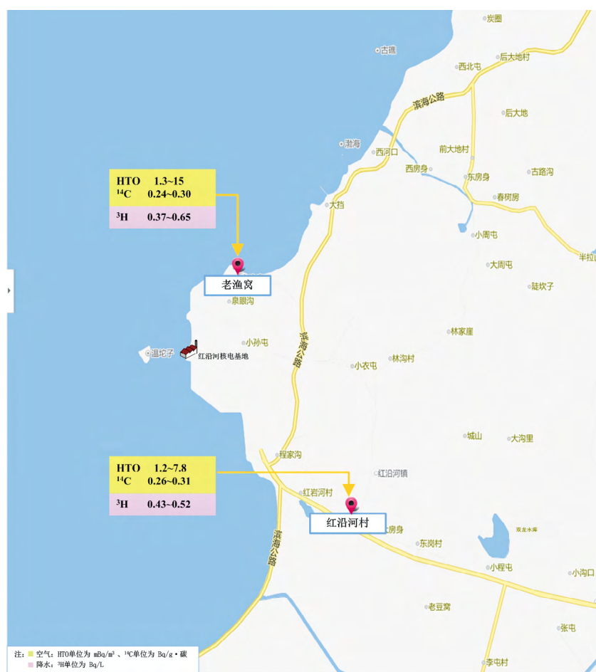
图 4.6-2 红沿河核电基地周围空气中氚化水（HTO）、碳-14和降水中氚监测结果
