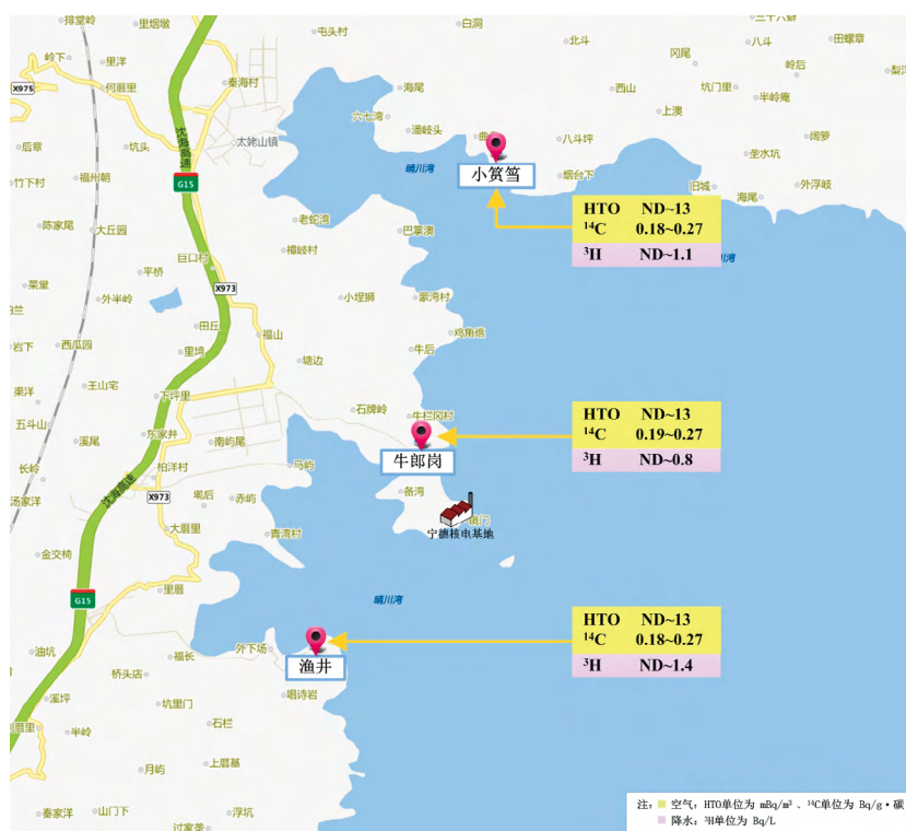
图 4.7-2 宁德核电基地周围空气中氘化水（HTO）、碳-14和降水氚监测结果
