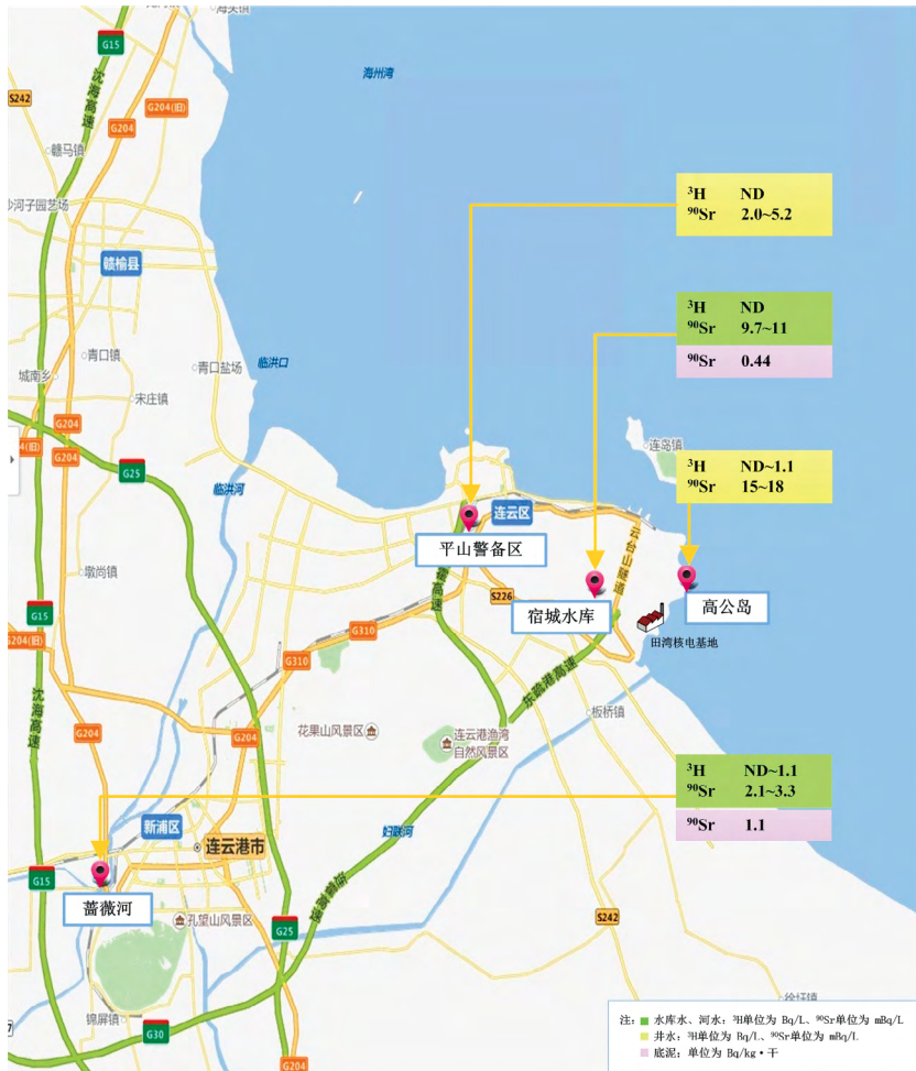
■ 图 4.5-4 田湾核电基地周围水库水、河水、井水和底泥监测结果分布示意图 (注：水库水、河水和井水中人工 \gamma 放射性核素 ^{54}\text{Mn} 、 ^{58}\text{Co} 、 ^{60}\text{Co} 、 ^{65}\text{Zn} 、 ^{95}\text{Zr} 、 ^{110\text{m}}\text{Ag} 、 ^{124}\text{Sb} 、 ^{134}\text{Cs} 、 ^{137}\text{Cs} 、 ^{144}\text{Ce} 等均未检出；底泥中人工 \gamma 放射性核素 ^{54}\text{Mn} 、 ^{58}\text{Co} 、 ^{60}\text{Co} 、 ^{95}\text{Zr} 、 ^{110\text{m}}\text{Ag} 、 ^{134}\text{Cs} 、 ^{137}\text{Cs} 、 ^{144}\text{Ce} 等均未检出。)
